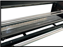
Barra oscilante facilita la optimización para aumentar las resistencia y estabilidad.
