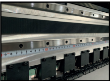
Viga más ancha y gruesa con doble guía silenciosa THK.
